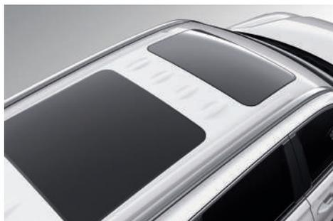
Двухсекционная панорамная крыша
