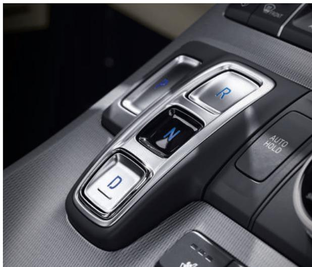
Переключение режимов 8-ступенчатой автоматической коробки передач кнопками
