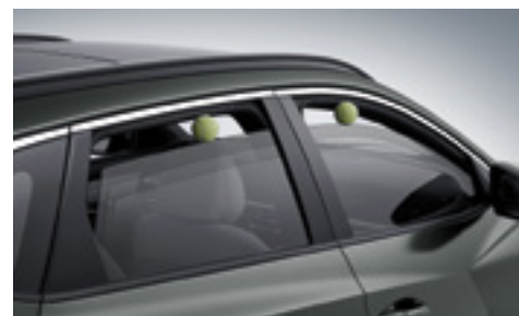
Қысылып қалудан қорғау функциясы бар электрлі әйнек көтергіштер
